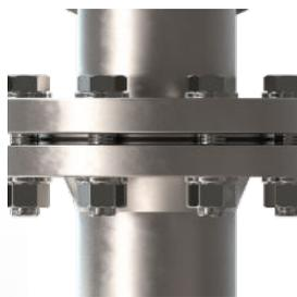
4. Stecken Sie die Schrauben durch die Flansche und schrauben Sie die Muttern auf. Verwenden Sie dabei jeweils unter dem Schraubenkopf, sowie unter der Mutter eine Unterlegscheibe (siehe Bild). Ziehen Sie die Schrauben handfest an.
