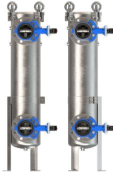
2. Legen Sie anschließend die zwei oberen Absperrklappen auf die Flansch. Ggf. müssen diese etwas gehalten werden, damit sie nicht vom Gehäuse kippen. Achten Sie hierbei auf die korrekte Ausrichtung der Klappen: Siehe Bild.
