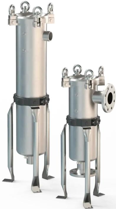
Das zu filtrierende Medium tritt durch den seitlichen Eingang in das Filtergehäuse ein. Die Feststoffverunreinigungen verbleiben im Filterbeutel und das gereinigte Filtrat verlässt das Gehäuse durch den Ausgang am Boden.
