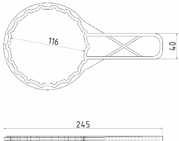
Der Haltewinkel und der Montageschlüssel sind aus Polypropylen gefertigt
