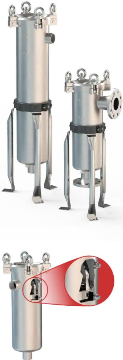
Das zu filtrierende Medium tritt durch den seitlichen Eingang in das Filtergehäuse ein. Die Feststoffverunreinigungen verbleiben im Filterbeutel und das gereinigte Filtrat verlässt das Gehäuse durch den Ausgang am Boden.
