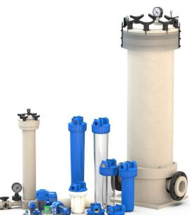
Die Besonderheit dieses Beutelfiltergehäuses liegt darin, dass alle medienberührenden Teile aus Polypropylen gefertigt sind. Somit eignet sich dieses Beutelfiltergehäuse vor allem für Anwendungen, bei denen Werkstoffe wie z.B. Edelstahl nicht beständig sind (Salzund Schwefelsäure, Meerwasser, flüssigen Kohlenwasserstoffen, Alkoholen, konzentrierten Laugen etc.).
