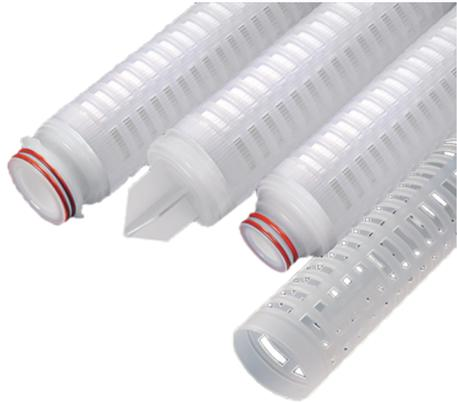
Das Element besteht aus einer gefalteten Borosilikat Mikrofaser Membran. Diese besitzt eine natürliche positive Ladung, was die Abscheidung von negativ geladenen Teilchen wie z.B. kolloidale Partikel erleichtert.
